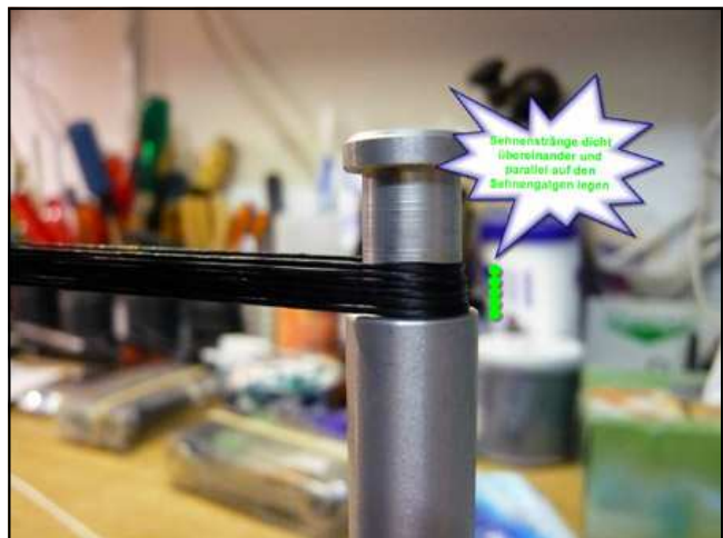
Sehnenstränge dicht übereinander und parallel auf den Sehnenlängen legen.
