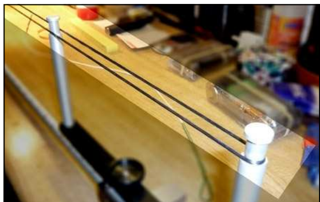
Abgezählte Fäden: 8 Runden für eine 16 Strang Sehne.
