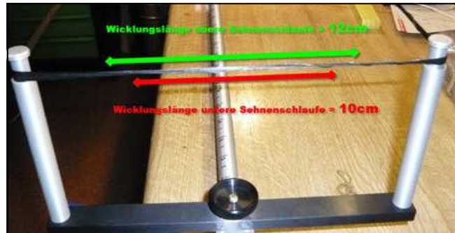
Wicklungslänge obere Sehnenschlaufe = 12 cm Wicklungslänge untere Sehnenschlaufe = 10 cm
